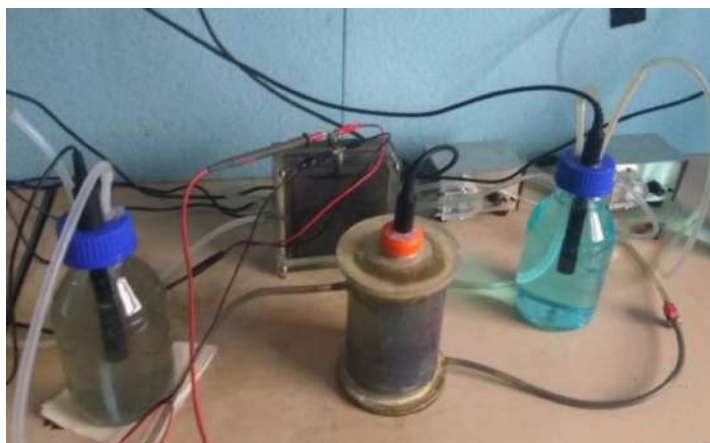
Фигура 26. Снимка на биоелектрохимичната система - тип сандвич, при Вариант 2;
