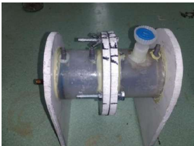
Фигура 24. Снимка на микробната горивна клетка при Вариант 1.
